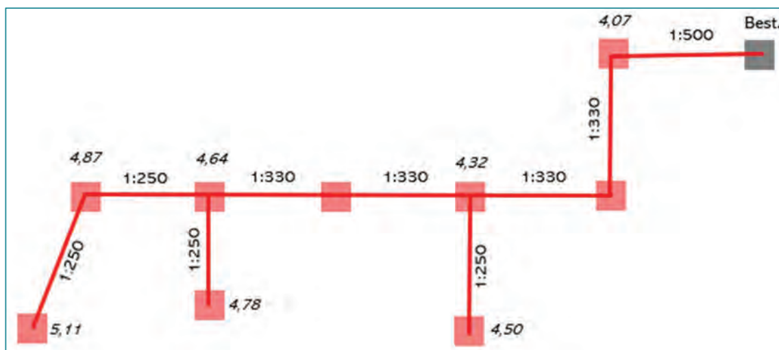
Figuur 8 Schematisch ontwerp VWA-riool, voorzien van B.O.B.'s en verhang.
